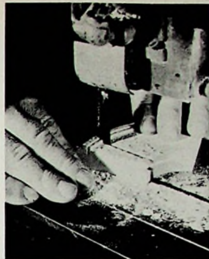
Glas-keramiek kan met standaard machines worden bewerkt.
